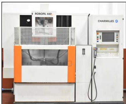
CHARMILLES ROBOFIL 440CC 4-axis CNC wire EDM
