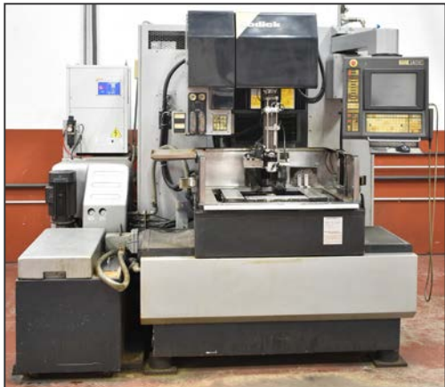
SODICK AQ325L 4-axis CNC wire EDM
