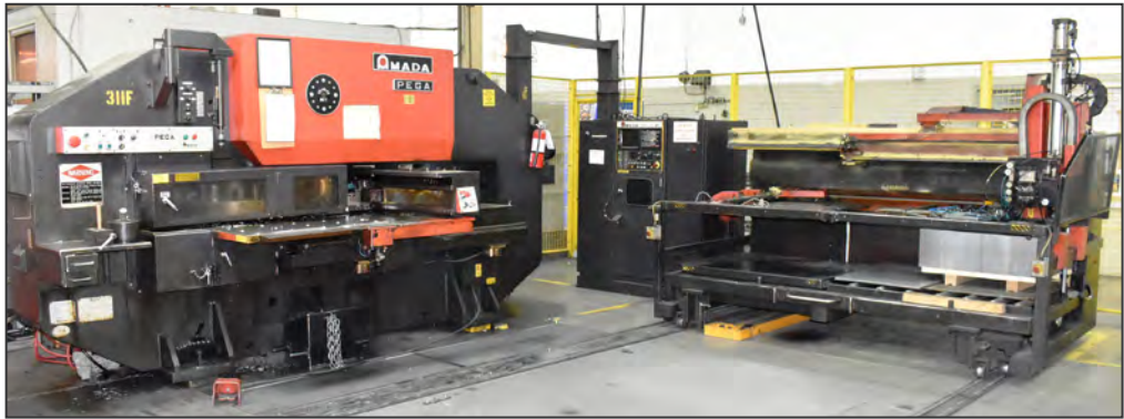
AMADA PEGA-304040 30 ton CNC turret punch
