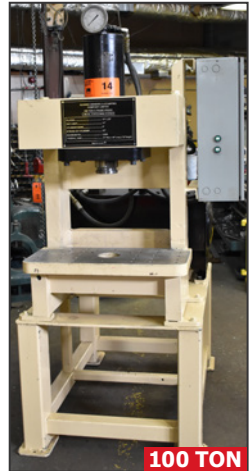
ALKANO HP 2P 32/19 c-frame hyd stamping press
