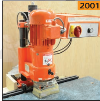
2001 BLUM mini press euro hinge drill
