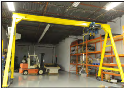
DEMAG 5 ton rolling A-frame gantry
