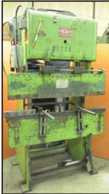
CHICAGO 135 4' X 15 ton press brake
